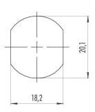
Schaltschrankdurchführung mit Durchgangsbohrung Lead-through for control cabinet with bore hole
